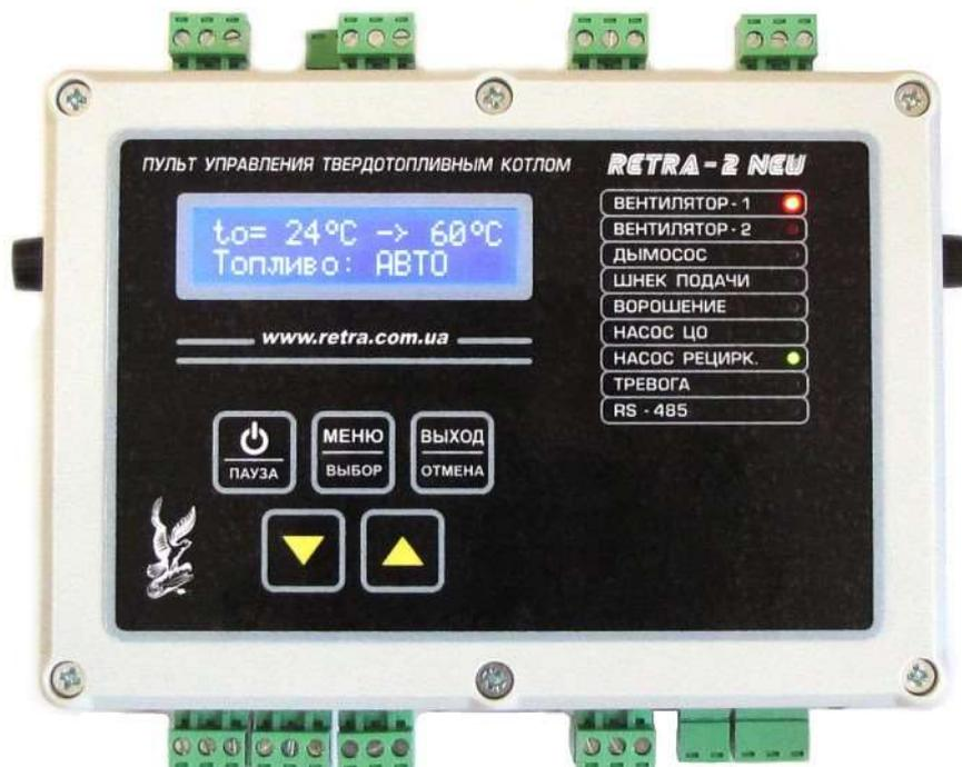
Пульт управления твердотопливным котлом
