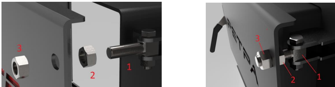
Рис.19 Схема підтяжки завісів
