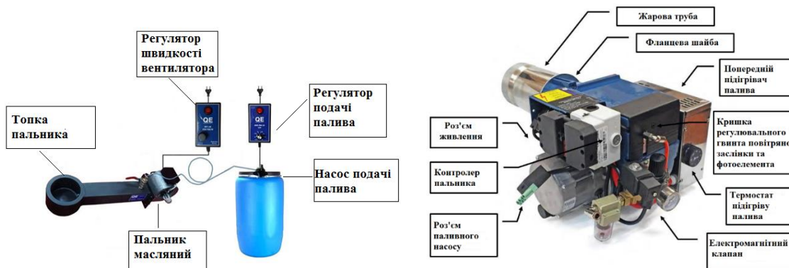
Рис.3б Будова комплекту масляного паливника до котла «Retra-Light»
