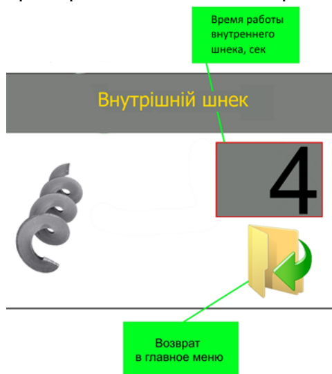
Рисунок 16 – Окно настройки работы внутреннего шнека
