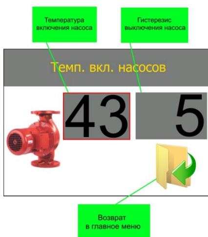
Рисунок 26 – Окно изменения параметров насоса
