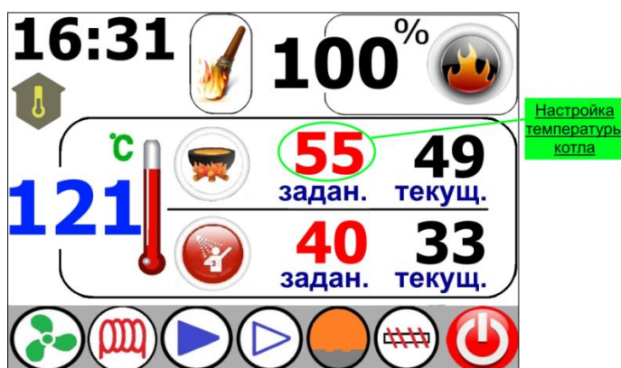
Рисунок 11 – Изменение температуры котла
