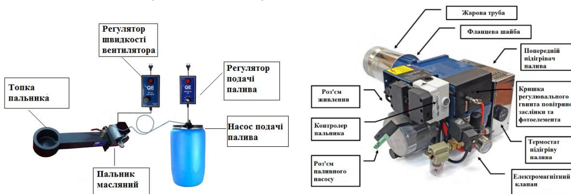
Рис.2в Будова комплекту масляного пальника до котла «Retra-Light»
